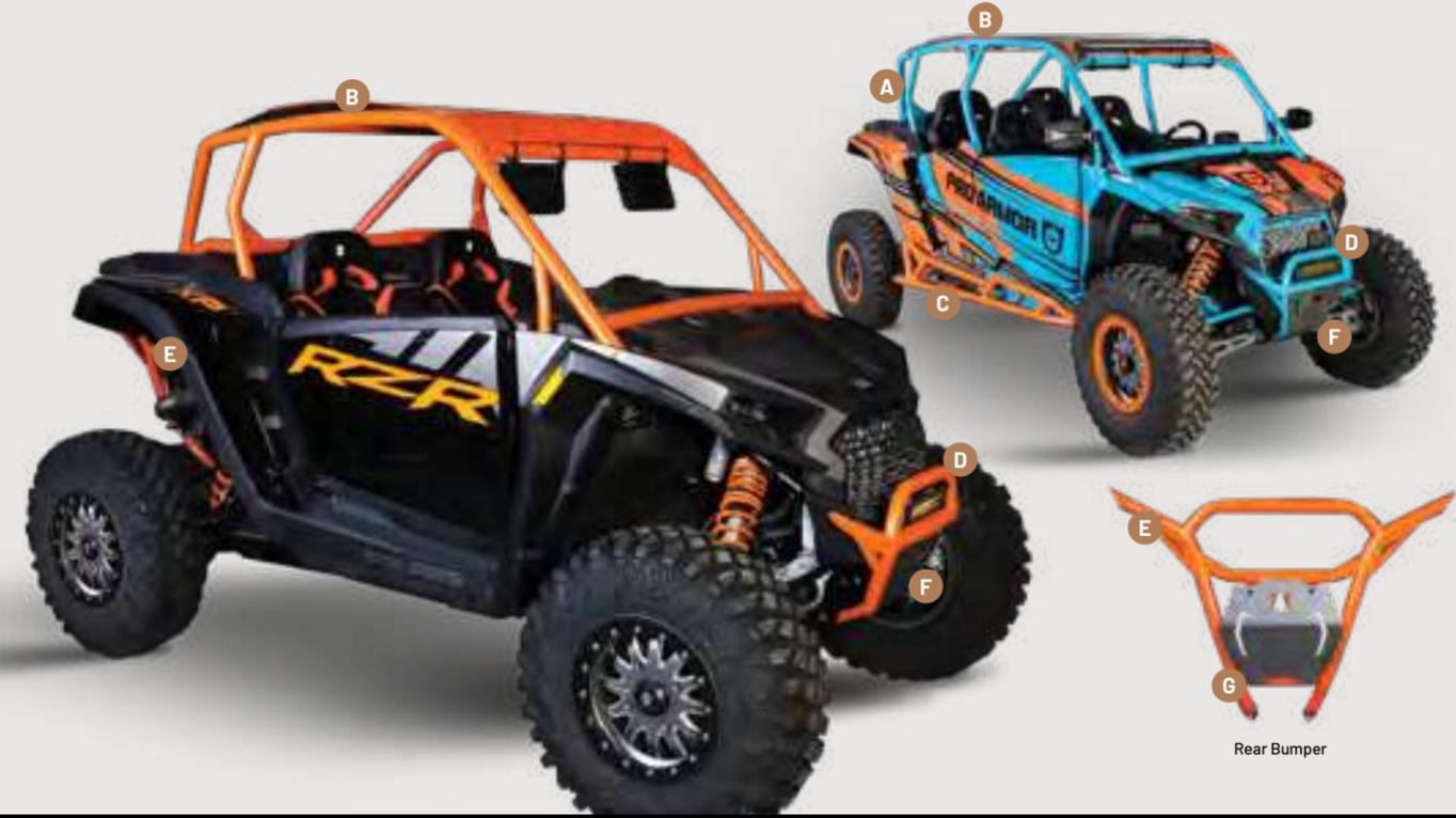
**A CAGE B ROOF C ROCK SLIDERS**
