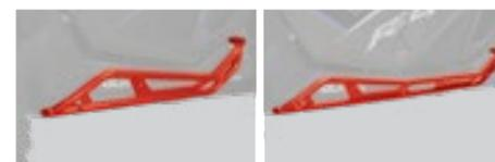
CONSTRUCTION EN ACIER TUBULAIRE DE 1,75 po AVEC DES PAROIS 70 % PLUS ÉPAISSES, DÉPASSE DU VÉHICULE POUR UNE PROTECTION MAXIMALE SUR LES TERRAINS DIFFICILES.
