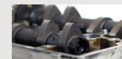
**ARBRE À CAMES :** Des arbres à cames en tête à action directe sont utilisés sur plusieurs moteurs Polaris. Dans ce cas, l'arbre à cames pousse directement sur la soupape créant des pressions de contact très élevées comparativement aux autres configurations d'arbre à cames. Ces forces exercées sont tellement élevées qu'une huile de qualité inférieure peut se dégrader et entraîner une usure accrue et des dommages potentiels au moteur.
